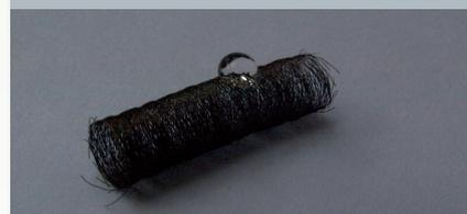
Stent (2) métallique dont la surface est traitée pour la rendre très hydrophobe, comme en témoigne la forme de la goutte d'eau déposée à sa surface.
