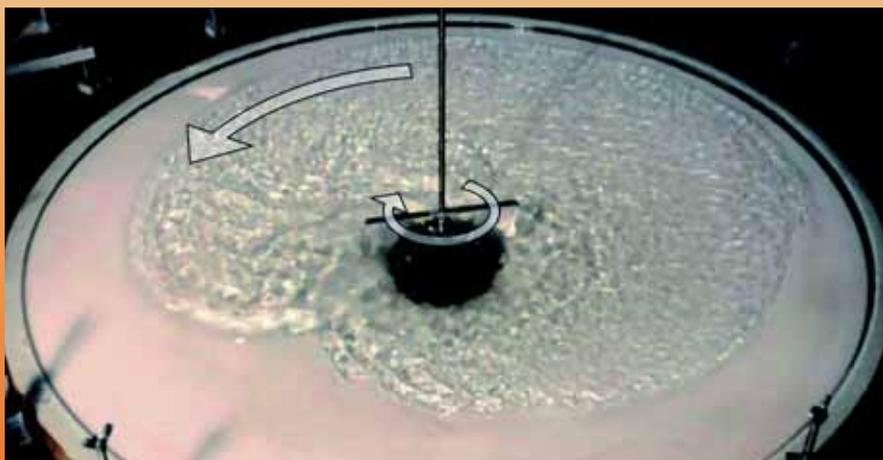
Ci-dessus : ressaut hydraulique observé lors de l'écoulement de l'eau dans un évier.
