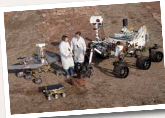
De g. à d.: Un rover de type Spirit/Opportunity, le petit Pathfinder, alias Sojourner et le rover Curiosity.
