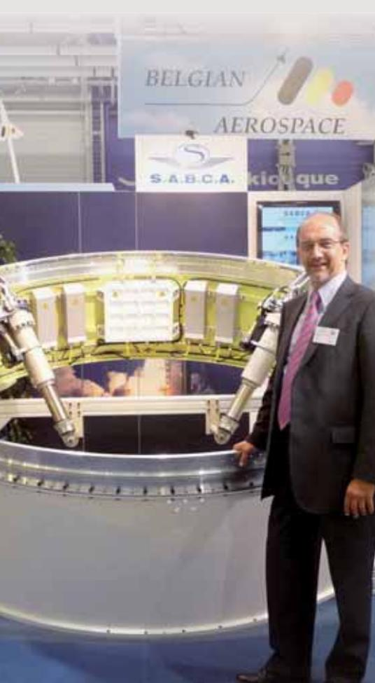
Base du 1<sup>er</sup> étage du lanceur européen Vega qui est piloté par le sous-système SABCA de servo-commandes électro-mécaniques.
