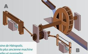
Schéma de la scierie à pierre romaine de Hiérapolis. Datant du 3<sup>e</sup> siècle après JC, c'est la plus ancienne machine connue utilisant un système de bielles et manivelles.
