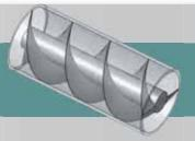
un point de vue fonctionnel, la vis d'Archimède (voir illustration ci-dessus) est une pompe qui sert encore à faire monter des liquides dans les stations d'épuration ou des céréales dans les silos à grains. Elle appartient à la famille des
