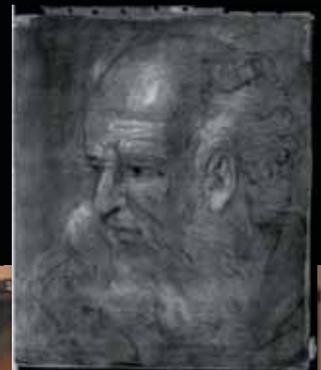
Dans la réflectographie infrarouge, les rayons infrarouges, radiations de même nature que la lumière, se caractérisent par des longueurs d'onde plus grandes et qui pénètrent donc plus profondément dans la matière, permettant ainsi de révéler des éléments sous-jacents à la surface visible.
