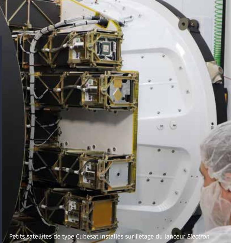
Petits satellites de type Cubesat installés sur l'étage du lanceur Electron
