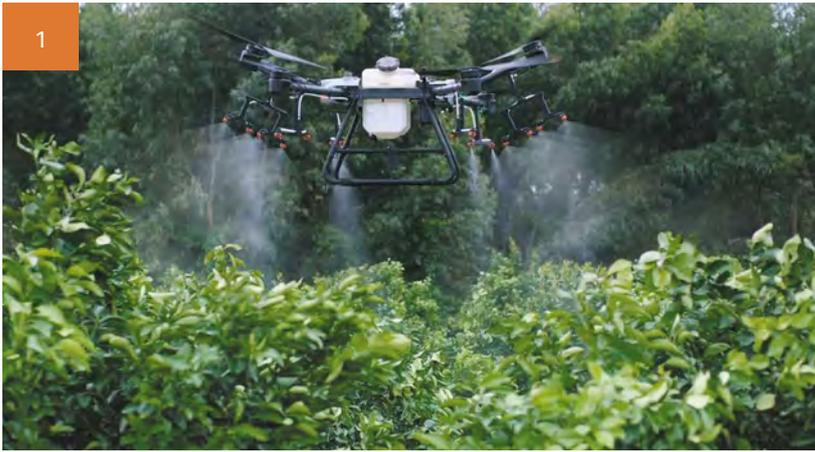
1. Le drone agricole *DJI Agras T30* en action: ici en phase de pulvérisation, il adapte sa trajectoire au terrain grâce à un radar et à des caméras à vision immersive.
